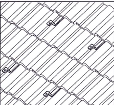
Stelle anzeichnen, an der der Ziegel auf dem Dachhaken aufliegt, dort Tropffalz mit Trennschleifer entfernen, Ziegel wieder einsetzen. Bei Biberschwanzeindeckung, entsprechenden Streifen aus Ziegel heraustrennen.
